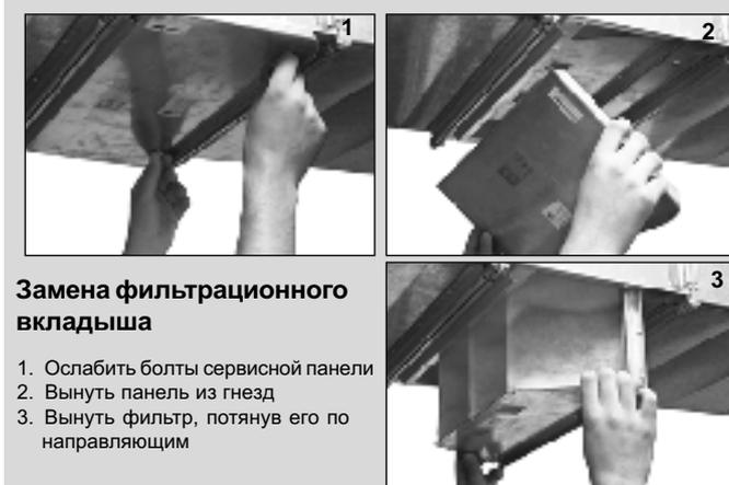
**Вставка кассетного фильтра VF3**
