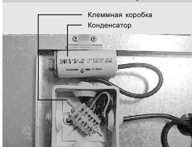
контакта подключить к управляющей системе, которая способна идентифицировать неисправность и защитить мотор от температурной перегрузки. При правильной работе системы управления, после охлаждения и замыкания термоконтактов мотор не включается авто-матически. Перед повторным пуском необходимо проверить зарегулирование сети и электрические параметры мотора и всей системы.
