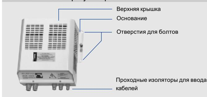
■ Регулятор мощности TRN лучше устанавливать вблизи вентилятора. Регулятор можно установить только вертикально или горизонтально на стену, на воздуховод или на вспомогательную конструкцию. Монтаж проводится следующим образом.
